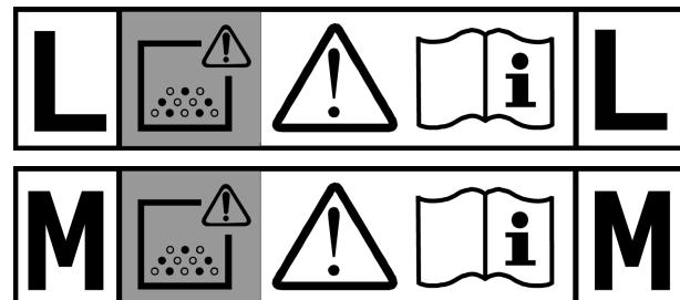
**- Waarschuwing:** Het apparaat kan gezondheidsbedreigende stoffen bevatten. Het leegmaken en het uitvoeren van onderhoudswerkzaamheden, inclusief de filtervervanging, mag uitsluitend worden gedaan door hiertoe bevoegde vaklieden met een geschikte veiligheidsuitrusting. Gebruik het apparaat uitsluitend met een volledig geïnstalleerd filtersysteem.
